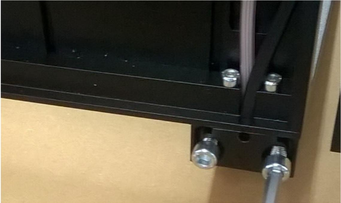
6. Das andere Ende des Standrohres etwas anheben und auf den Rand der Verpackung legen, danach die Senkschrauben herausdrehen.
