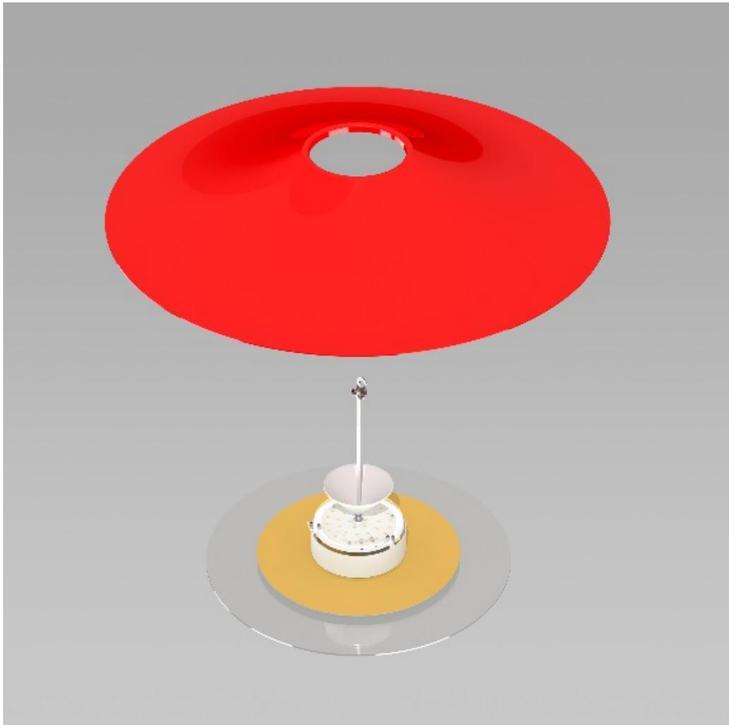
3. Die Abhängöhe festlegen, dazu die Anschlußleitung auf die gewünschte Länge kürzen und den Zugentlaster an der Pendelleitung befestigen. Dazu die Stahlseilseele in eine Klemmbuchse stecken und mit der Schraube sichern. Danach den Zugentlaster im bauseitigen Deckenhaken einhängen, die Leuchte anschließen und den Baldachin bis zur Decke hochschieben.
